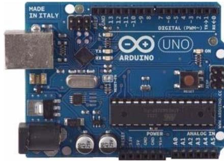
A modo de ejemplo mostramos la placa Arduino UNO que incorpora el chip ATmega328. Tienen 14 entradas/salidas digitales, 6 entradas analógicas, entradas de alimentación, conexión USB para conectar al ordenador, conector de alimentación y un botón de Reset.
